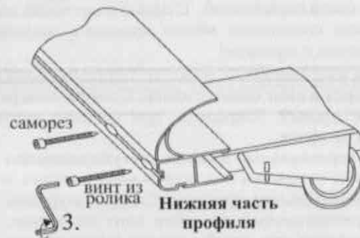
Рис. 2 Установка нижнего ролика
