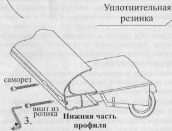
Рис. 2 Установка нижнего ролика
