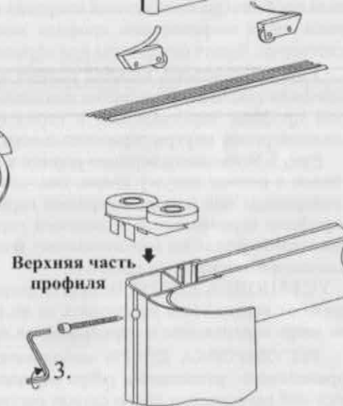
Рис. 3 Установка верхнего ролика при помощи шурупа 4,5x40
